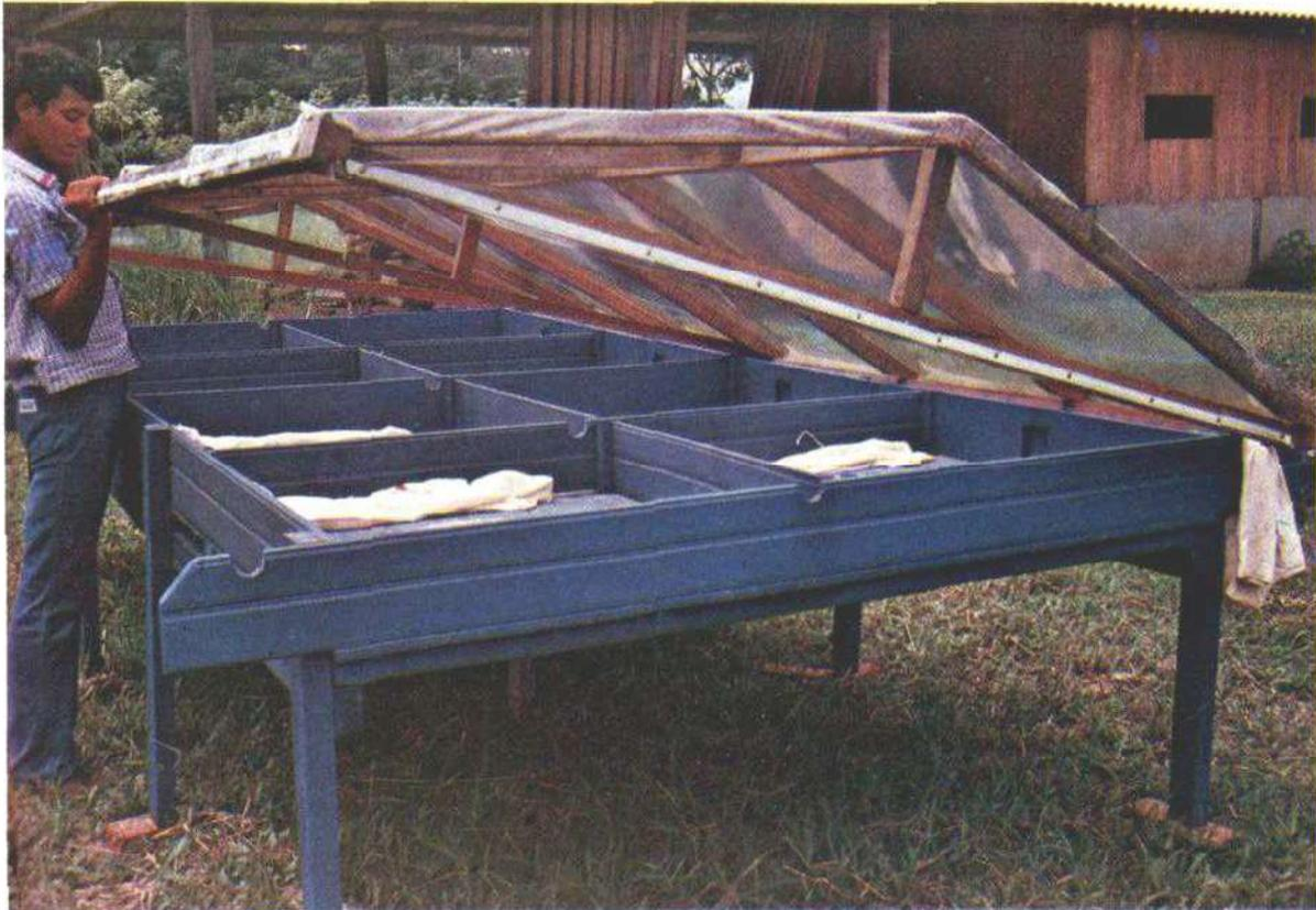
FIG. 38. Secador de madeira com cobertura plástica.
