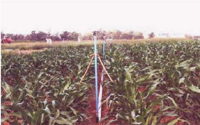
**Figura 4. Sistema de aspersão portátil com laterais móveis.**
