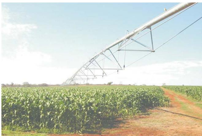
**Figura 6. Sistema pivô central (Fonte: Walfrido Machado, Emater-MG).**
