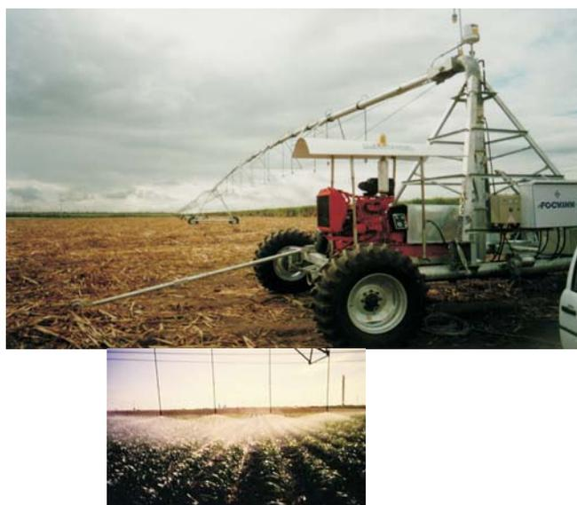
**Figura 7. Sistema de irrigação por deslocamento linear (fonte: FOCKINK).**
