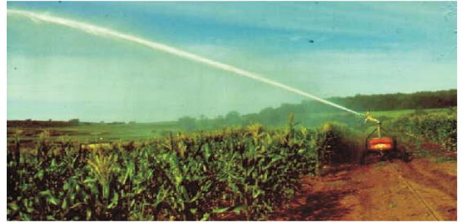
**Figura 5. Sistema de irrigação autopropelido**
