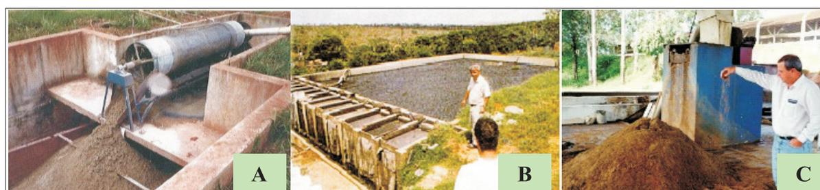
Figura 2. Exemplos de sistemas de separação de sólidos: (A) Peneira giratória; (B) Decantador celular; (C) Prensa mecânica.
