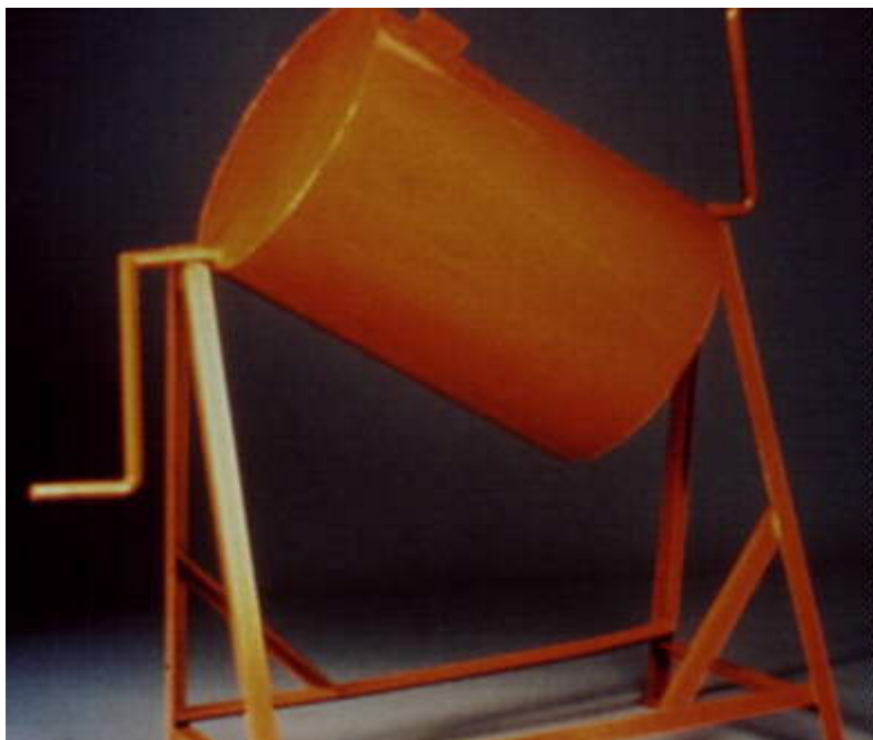
Figura 28. Tambor rotativo para tratamento de sementes.
