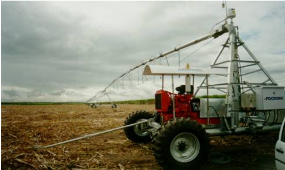
Figura 14. Sistema de irrigação por deslocamento linear. Fonte: FOCKINK.
