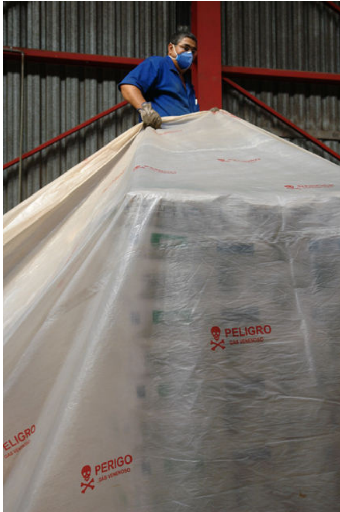
Figura 18. Cobertura das sacarias com lona plástica apropriada.
