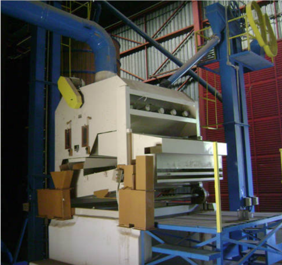
Figura 2. Máquina de ar e peneira utilizada para limpeza de grãos a granel.
