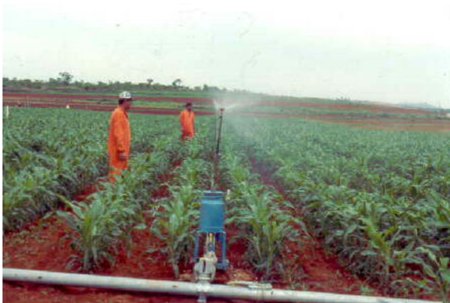
Figura 29. Equipamento portátil de injeção desenvolvido na Embrapa Milho e Sorgo denominado "vaquinha".
