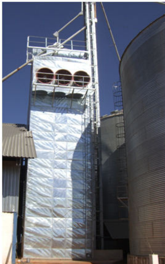
Figura 5. Secador de torre.
