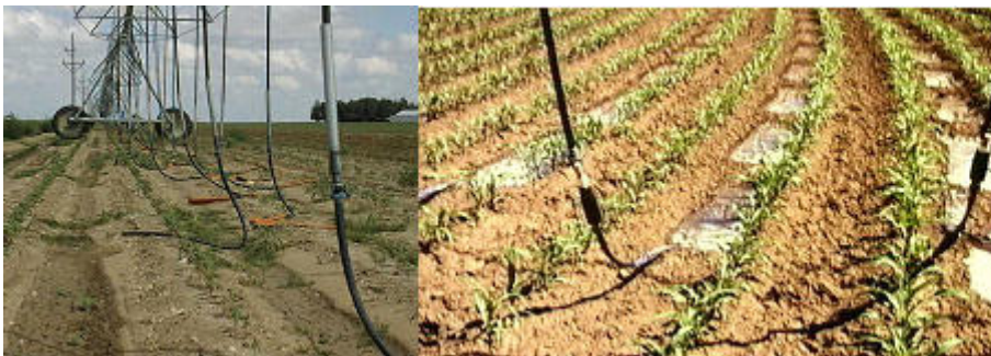
Figura 15. Sistema de irrigação do tipo LEPA. Fonte: USDA-ARS.
