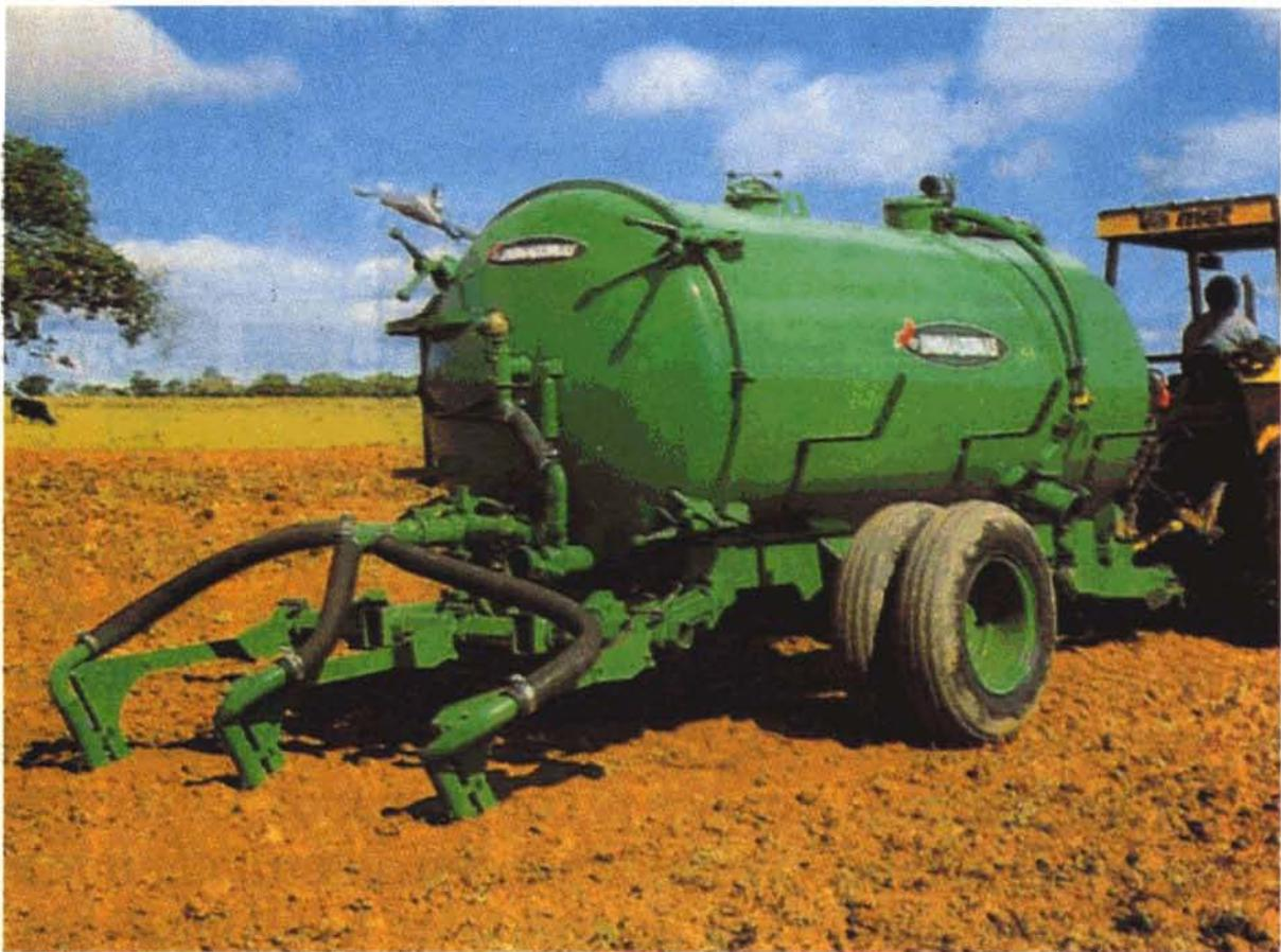
**Figura 4 .** Distribuição localizada, através de injeção no solo, com uso de equipamento tratorizado.
