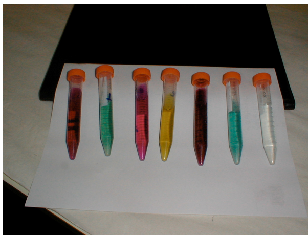
Figura 1. Testes para verificação da eficiência da redução de Cr (VI). Da esquerda para a direita, frascos 1, 3 e 5, coloração violeta, soluções que contêm resíduos de Cr (VI); frascos 2 e 6, coloração verde, Cr (III); frasco 4, solução acidificada; e frasco 7, branco.
