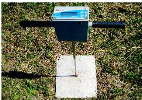
Figura 10. Penetrômetro dotado de sistema eletrônico para aquisição e armazenamento dos dados de resistência à penetração e das respectivas profundidades de medição.
