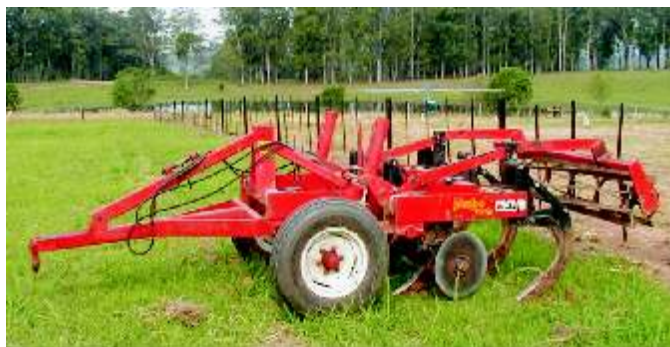
Figura 28. Exemplo de escarificador adequado para descompactação do solo em sistemas manejados sob semeadura direta.
