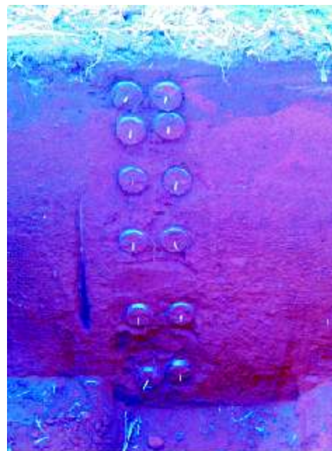
Figura 6. Cilindros volumétricos para coleta de amostras indeformadas destinadas à determinação da densidade do solo, os quais se encontram inseridos na parede vertical de uma trincheira.
