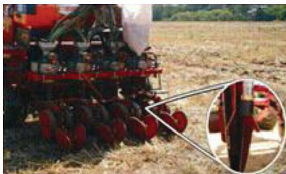
**Figura 21.** Semeadura de soja a campo com adaptador para inoculação no sulco.
