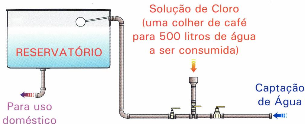
Figura 1. Cloração de água do reservatório
