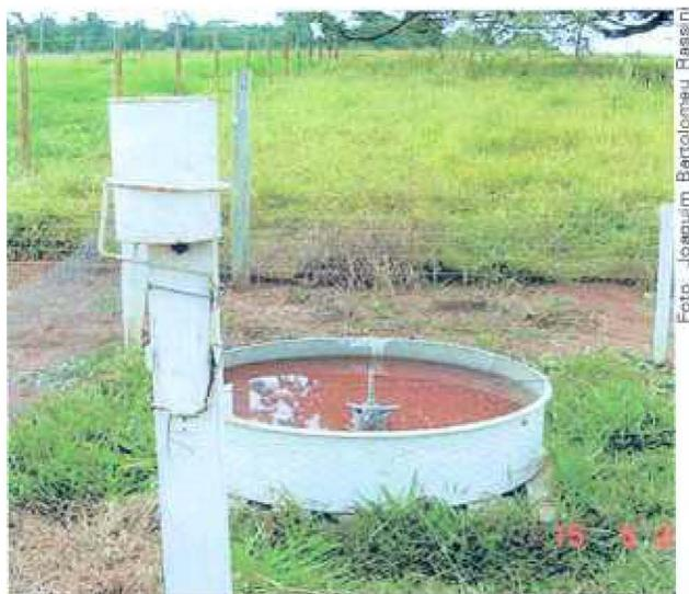
Fig. 2. Tanque classe A e pluviômetro, utilizados no manejo de irrigação com base no método EPS.
