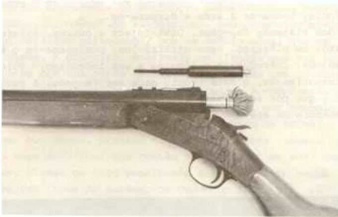
Fig. 37. Carabina Cap-chur com o dardo, o redutor de calibre 32 para 22 e o expansor lateral de gases.
