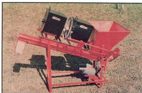
**FIGURA 3.** Tambor rotatório (acima) e máquina (abaixo) utilizadas para tratamento de sementes e inoculação.
