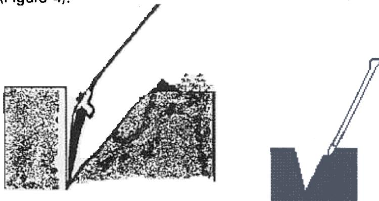
Figura 4. Corte de uma fatia de terra na parede vertical.
