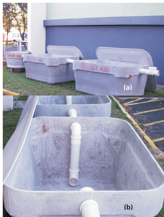
Figura 2 Foto de um biodigestor montado. a) vista lateral e b) vista superior.
