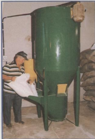
Foto 2 - Produtor carregando um misturador vertical.
