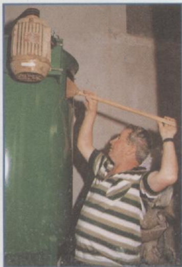
Foto 9 - Detalhe da limpeza da parte superior de um misturador vertical através de uma janela de inspeção.
