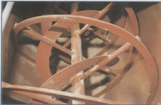
Foto 1 - Detalhes internos de um misturador horizontal provido de fitas.
