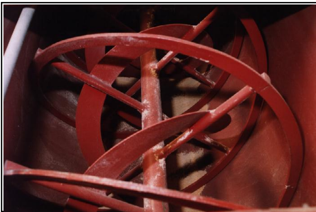
Foto 1. Detalhes internos de um misturador horizontal provido de fitas.
