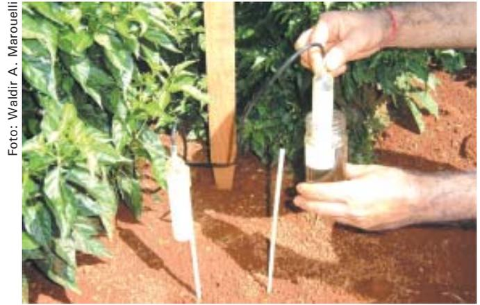
Fig. 11. Leitura de sensores Irrigas® instalados em lavoura de pimenta por meio da introdução da cuba de leitura dentro do frasco com água.
