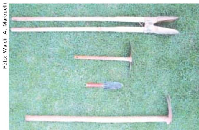
**Fig. 8.** Ferramentas (enxada pazinha de jardinagem, sacho e cavadeira) que podem ser utilizadas na abertura do buraco para a instalação de sensores Irrigas®.
