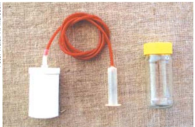
Fig. 7. Sistema Irrigas® artesanal construído com vela de cerâmica porosa para a filtragem de água (sensor), tubo flexível tipo espaguete, corpo de seringa de injeção sem o êmbolo (cuba) e vidro de conserva com tampa (frasco).
