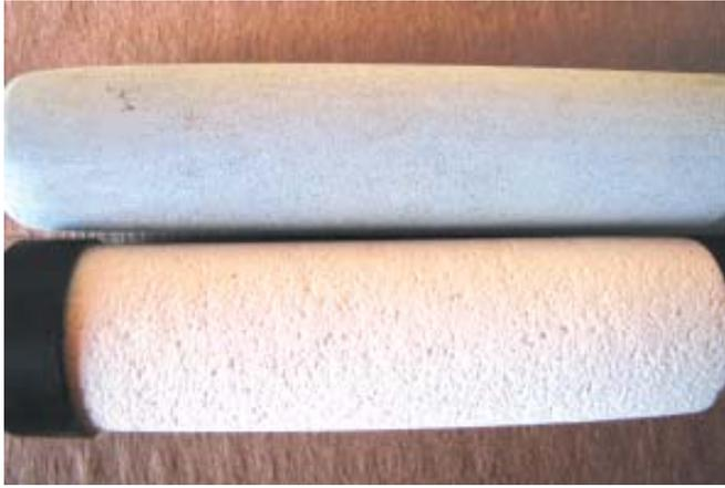
**Fig. 4.** Cápsulas porosas com diâmetro máximo de poros de 0,028 mm (cor branca) e 0,003 mm (cor cinza) para confecção de sistemas Irrigas® com tensões de referência de 10 kPa e 85 kPa, respectivamente.
