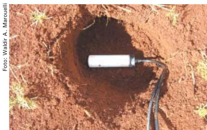
**Fig. 9.** Instalação de sensores Irrigas® raso e profundo, na posição horizontal, a 50% e 100% da profundidade efetiva em uma lavoura de cenoura em fase inicial.
