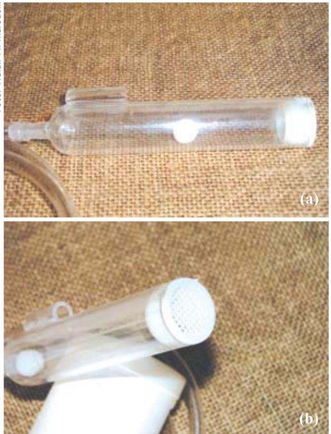
**Fig. 5.** Detalhe da esfera flutuante no interior da cuba (a), para facilitar a leitura durante o teste de imersão, e da tela para a contenção da esfera (b).
