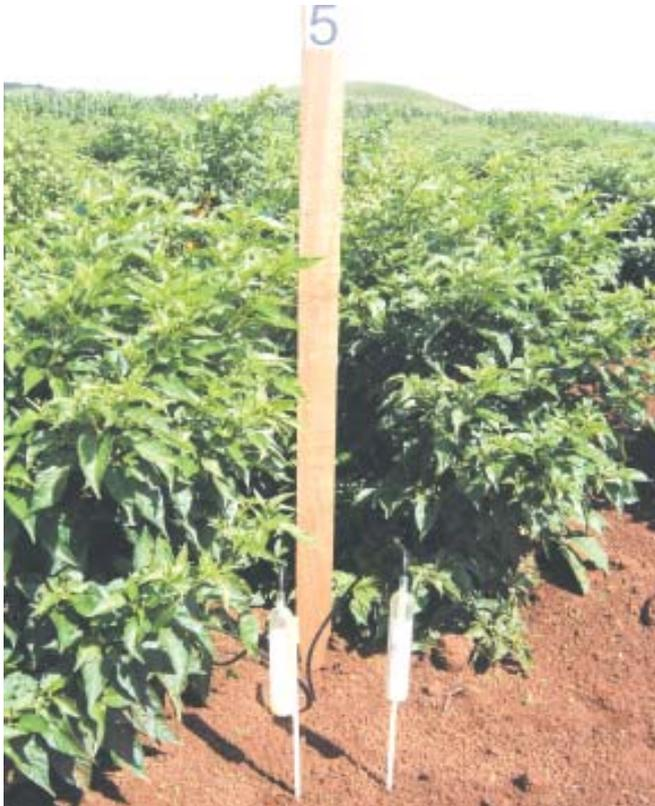
Fig. 10. Estação de controle sinalizada por uma estaca de madeira, com sensores Irrigas® raso e profundo instalados a 50% e 100% da profundidade efetiva do sistema radicular de uma lavoura de pimenta.
