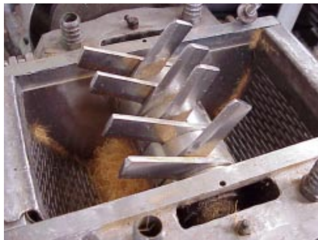
Figura 2. Detalhe das facas do moinho.
