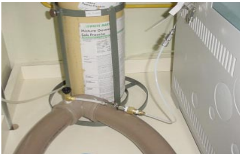
Figura 10. Análise do ar ruminal: alimentação do cromatógrafo com amostra de ar da canga pressurizada.
