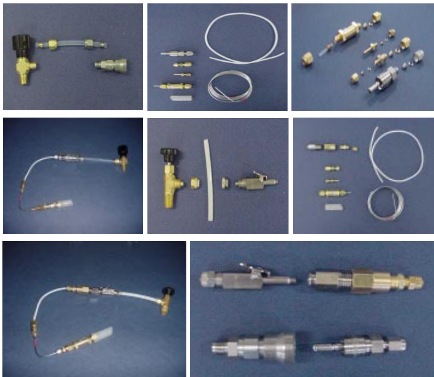
Figura 6. Peças componentes da válvula da canga, do sistema de tubo capilar e do engate rápido (da esquerda para a direita e de cima para baixo): a) válvula + parte fêmea do engate rápido Swagelok ® ; b) peças completas da parte macho do engate rápido Swagelok ® , união de redução, conexão de redução e filtro com ponteira de tubo de PTFE e pedaço de tubo de silicone, além de tubo de PTFE de 1/8" e rolo de tubo capilar em aço de 1/16"; c) peças individualizadas do filtro, conexão de redução, união de redução, parte macho do engate rápido Swagelok ® , com destaque para as anilhas e porcas de conexão; d) sistema completo desde filtro até válvula da canga; e) válvula + parte macho do engate rápido na versão nacional; f) peças completas da parte fêmea do engate rápido nacional, luva de redução, conector macho; união de redução; conexão de redução, filtro e tubo de silicone, além de tubo de PTFE de 1/8" e tubo capilar em aço de 1/16"; g) sistema completo, mais barato, desde filtro até válvula da canga; h) engate rápido nacional (acima), e Swagelok ® (abaixo).
