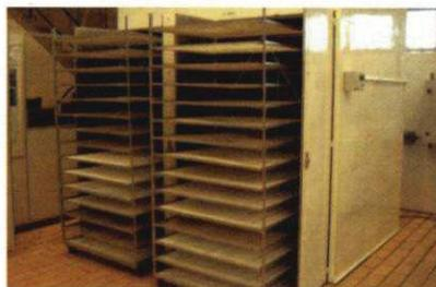
O equipamento surgiu como alternativa simples para secagem da pimenta dedo-de-moça da região de Turuçu/RS, evitando assim a influência das oscilações climáticas, a contaminação por agentes externos e o desperdício de matéria-prima durante a secagem natural que leva até três dias para ser concluída. O modelo tipo cabine melhorou o fluxo de ar aquecido, evitando a queima ou secagem insipiente, concluindo processo em algumas horas.
