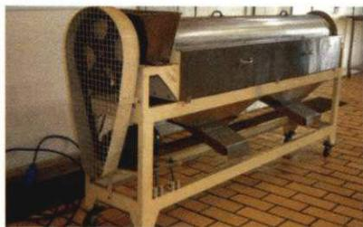
A abrasão mecânica das sementes de urucum num cilindro telado retira a película que a reveste resultando num concentrado rico em bixina, substância responsável pela pigmentação vermelha. A cada 1% de bixina adicional, o mercado paga US\$ 1/kg de semente. Assim, com o processamento das sementes, o produtor obtém um concentrado que pode chegar a 14% de bixina. O produtor ganha
