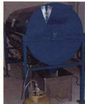
obtenção do cupulate (chocolate feito a partir da manteiga da semente de cupuaçu). Para a secagem utiliza-se o sistema de ventilação instalado em uma das extremidades. Um conjunto de queimadores infravermelhos instalados ao longo da estrutura metálica permite a homogeneidade da temperatura com a movimentação da matéria prima no interior da câmara. Para a torração, entra em cena o sistema de aquecimento constituído pelos queimadores infravermelhos e a movimentação mecânica da câmara de secagem.
