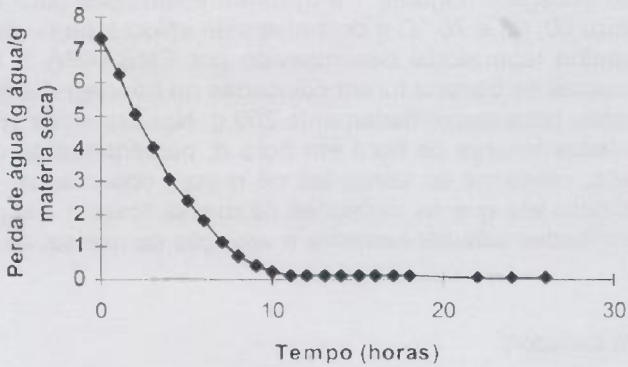
Figura 1 - Curva de secagem expressa em função da perda de água (g água/g matéria seca) versus tempo para temperatura de 60°C, velocidade do ar de 1,0 m/s e umidade relativa interna de 17%.
