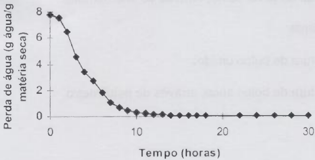
Figura 2 - Curva de secagem expressa em função da perda de água (g água/g matéria seca) versus tempo para temperatura de 60°C, velocidade do ar de 1,5 m/s e umidade relativa interna de 17%.
