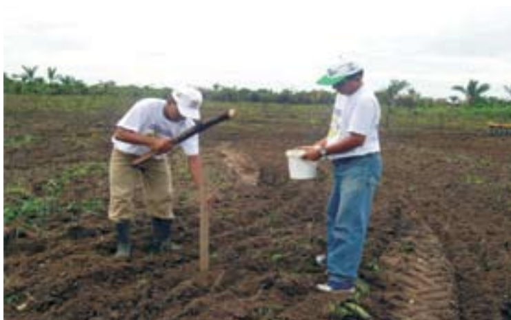
Fig. 1. Detalhe da coleta de amostras de solo para determinação da fertilidade da área utilizando tubo de PVC rígido de uma polegada com a ponta biselada.
