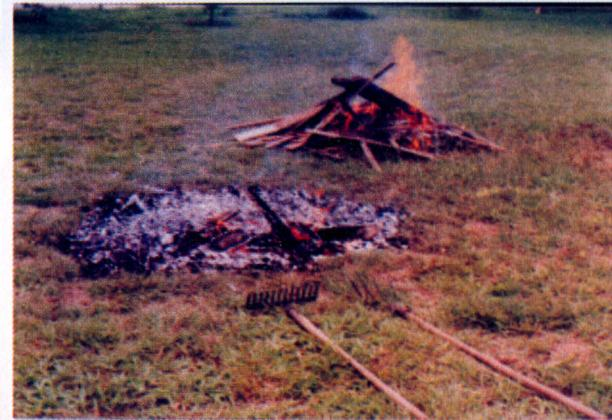
**Fig. 1.** Queima de madeira e espalhamento da brasa numa área circular, com diâmetro de 2,0 m.
