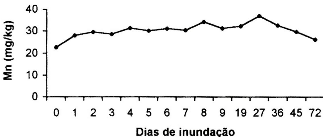
FIG. 8. Variação no teor de manganês do solo da várzea do rio Caeté, em função do tempo de inundação.
