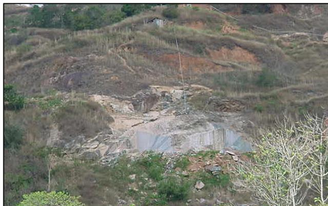
Fig. 22. Extração de rocha ornamental (nome comercial: Granito Coral), nos aplogranitos da Unidade Trajano de Morais
