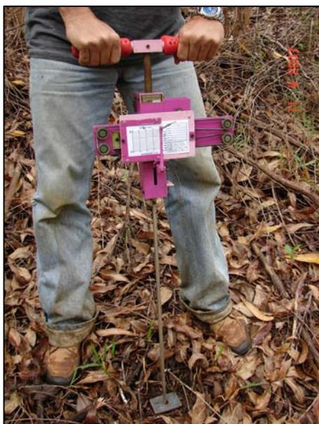
Fig. 6. Medição da resistência do solo à penetração com auxílio de penetrógrafo.
