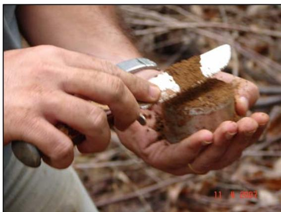
Fig. 4. Coleta de amostra indeformada de solo com anéis volumétricos.
