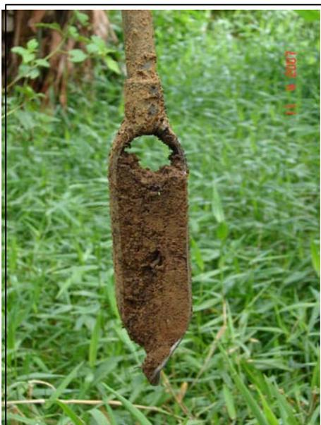
Fig. 5. Coleta de amostra deformada de solo com trado holandês.
