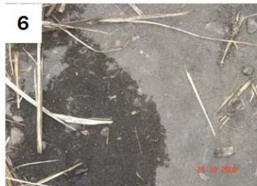
Fig. 6. Detalhe da frente de molhamento, gotejador enterrado.
