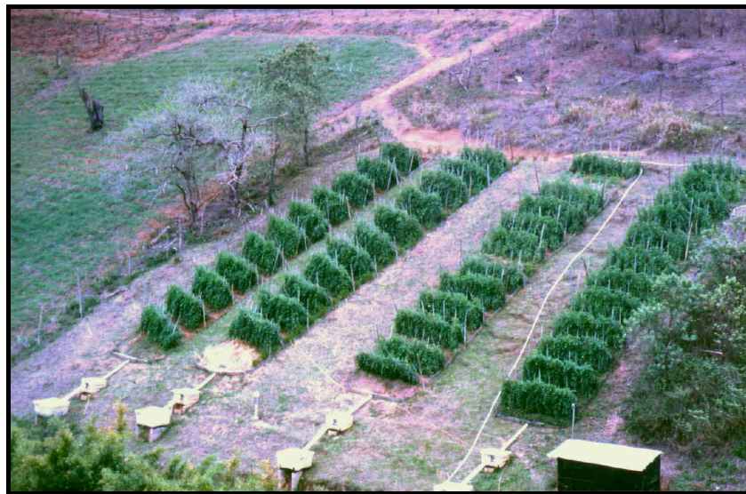
Figura 6.4. Parcelas do tipo Wischmeier para quantificação de erosão em terras de agricultor.
