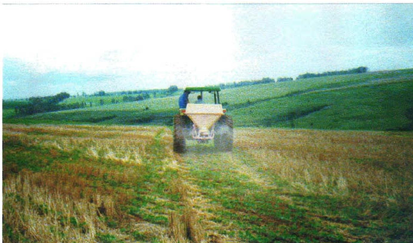
**Figura 2.** Adubação a lanço com potássio na área em estudo com distribuidor de fertilizantes com mecanismo distribuidor do tipo pendular. Carambel, PR.
