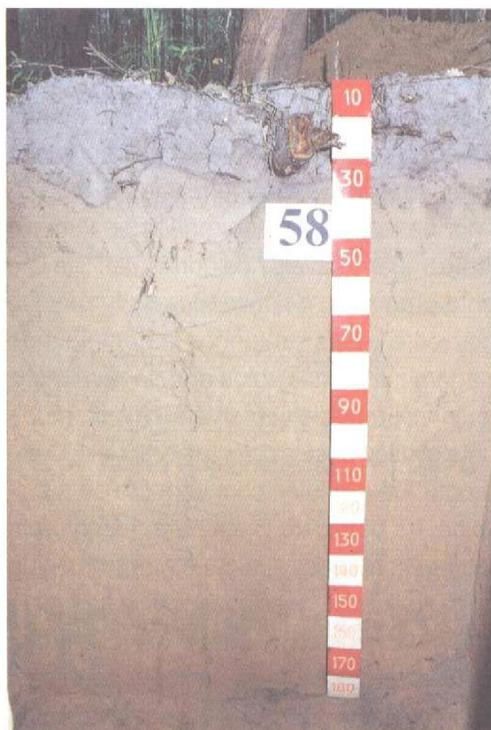
Figura 7: Perfil de Podzólico Amarelo abrupto textura arenosa/média/argilosa. região do sul da Bahia. Marcante contraste de cor e textura entre os horizontes.
