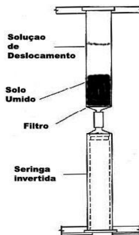
Fig. 4 - Esquema de montagem de coluna para extração de solução de solo (Wolt, 1994).
