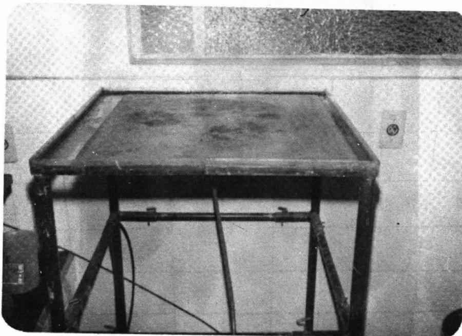
Fig. 1 - Vista da parte superior da mesa de tensão com as folhas do mata-borrão já impregnadas com argila, prontas para serem usadas.
