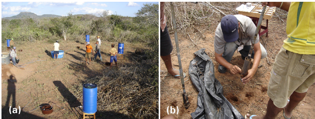
Fig. 3.1. Trabalhos de campo: (a) bateria de testes de infiltração; e (b) amostragem de solos para determinação de umidade com auxílio do trado de caneco.
