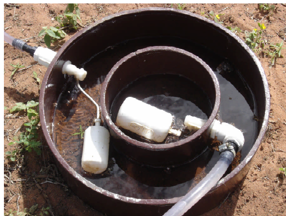
Fig. 3.2. Cilindros infiltrômetros e bóias utilizadas nos testes de infiltração.
