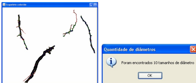
Fig. 19. Esqueletos coloridos conforme o tamanho dos diâmetros
