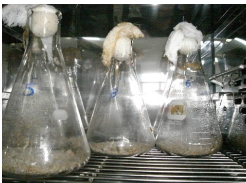
Fig. 1. Fermentação semi-sólida em frascos.
