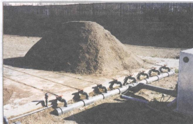
Figura 2. Pilha estática aerada em escala piloto.
