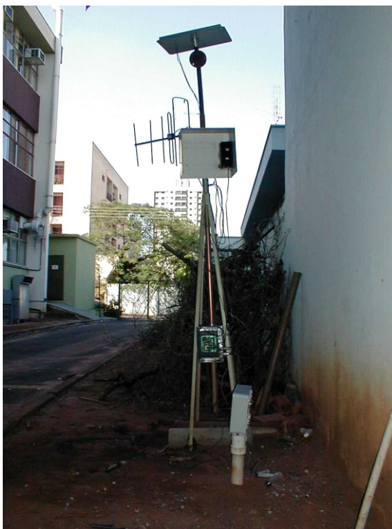
Figura 7. (a) Esquema de montagem para a avaliação da sonda no campo. (A) Sonda de análise; (B) Sistema de conversão e transmissão dos dados; (C) Sistema de recepção, aquisição e tratamento dos dados. (b) Foto do sistema montado no solo próximo ao laboratório.
