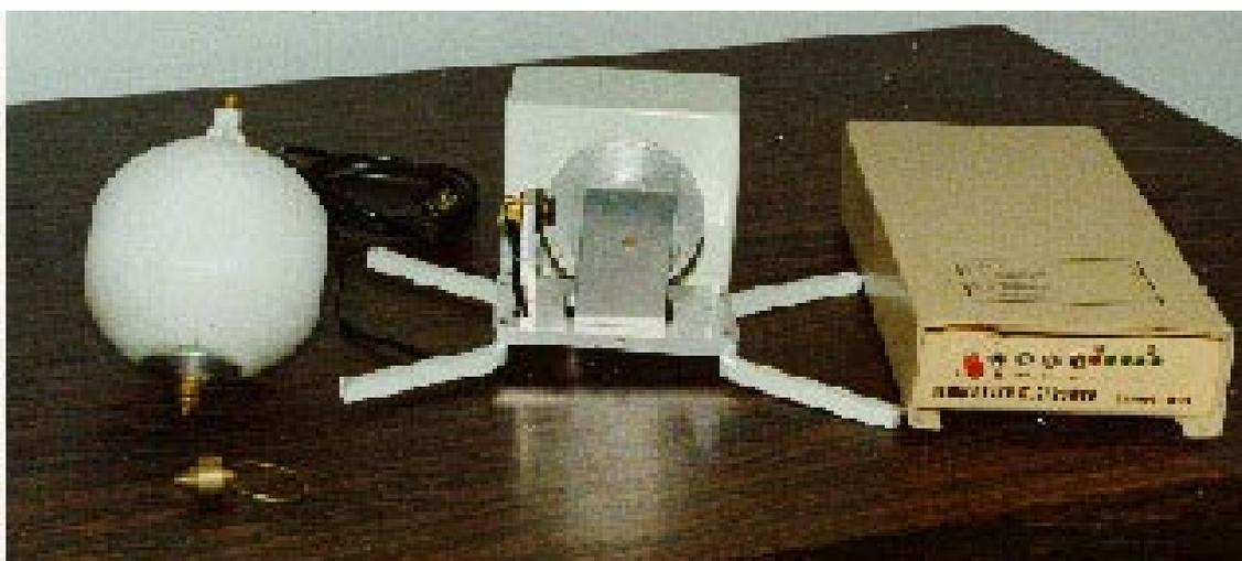
Figura 1- Detalhes mecânicos do sistema, da esquerda para a direita, tem-se o contrapeso e bóia; seguido do sensor de nível contendo os sensores ópticos com furos defasados de 1mm de centro a centro e disco metálico perfurado e unidade de processamento de dados.
