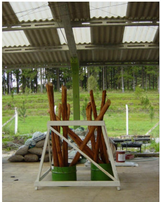
Fig. 1. Fotografia de suporte e recipiente com mourões durante tratamento ao abrigo de chuva em galpão.
