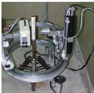
Figura 1- Tomógrafo analisando amostra dentro de um tubo de PVC
