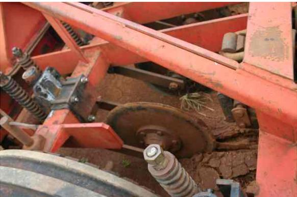
Fig. 8 - Isolação elétrica do disco de corte com manta de borracha
