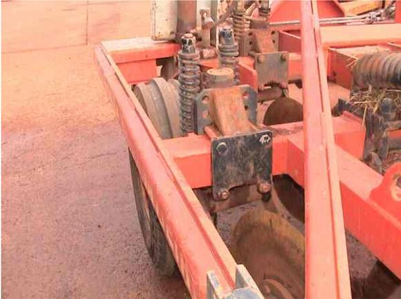
Fig. 7 - Fixação do disco a armadura do subsolador.
