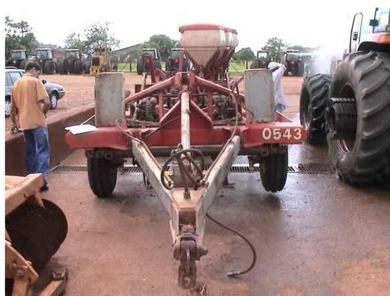
Fig. 5 - Foto subsolador de propriedade da Usina São Martinho, para adaptação para medida de condutividade elétrica.
