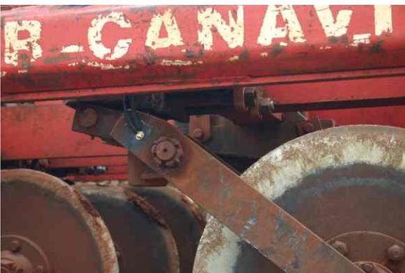
Fig. 9 - fixação do contato elétrico do disco com o cabo.
