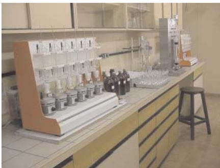
**Fig. 4.** Equipamentos de Extração de óleo, tipo Randall
