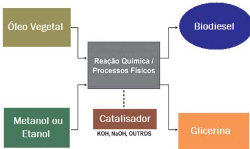
Fig. 3. Processo de obtenção de biodiesel.
