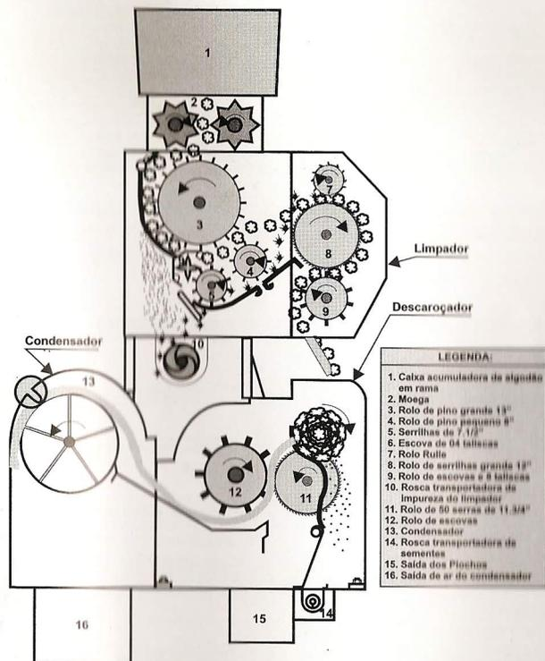
Figura 2. Esquema de funcionamento do minidescarçador.
