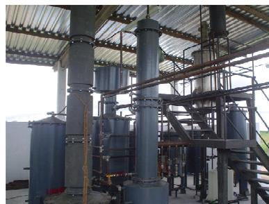
Fig. 10. Usina de transesterificação com capacidade para 240 l/dia.
