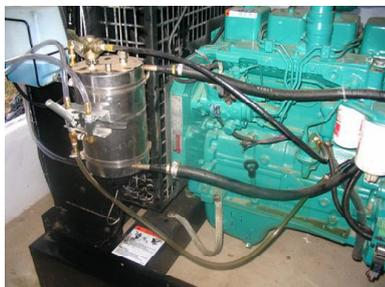
Fig. 11. Grupo-gerador Cummins movido a óleo de mamona *in natura* utilizando kit de conversão, instalado na Fazenda Normal, Quixeramobim, CE.
