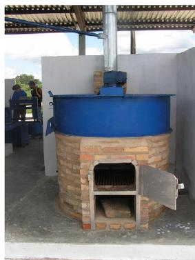
Fig. 7. Cozinhador utilizado para aquecimento das sementes
