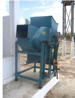
Fig. 5. Descascador de mamona, marca GSDOURADO, móvel, acionado pelo trator e sem discos de borracha.
