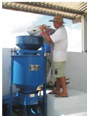
Fig. 4. Descascador de mamona, marca ECIRTEC, estacionário, com motor elétrico e discos de borracha.
