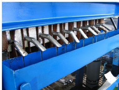
Fig. 9. Detalhe da saída do óleo do filtro prensa.
