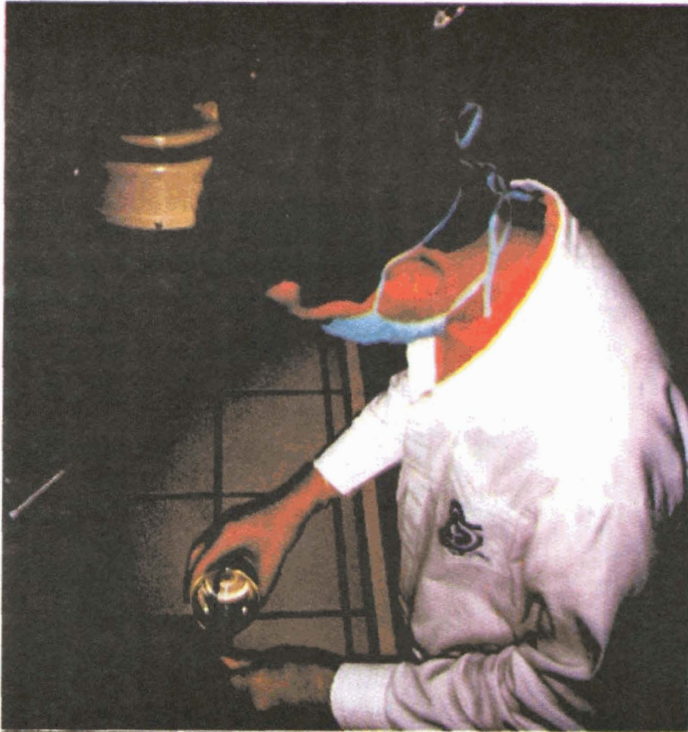
Figura 8. Solução de acrilamida para gel de eletroforese de isoenzimas sendo vertida na placa.
