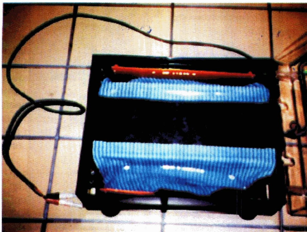
Figura 9. Ponte de contato entre o gel e uma solução-tampão, utilizando-se tecido poroso, durante uma corrida eletroforética.
