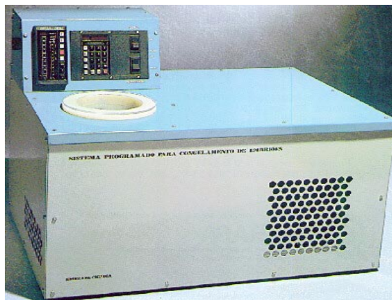
Figura 4 : Sistema de congelamento automatizado
