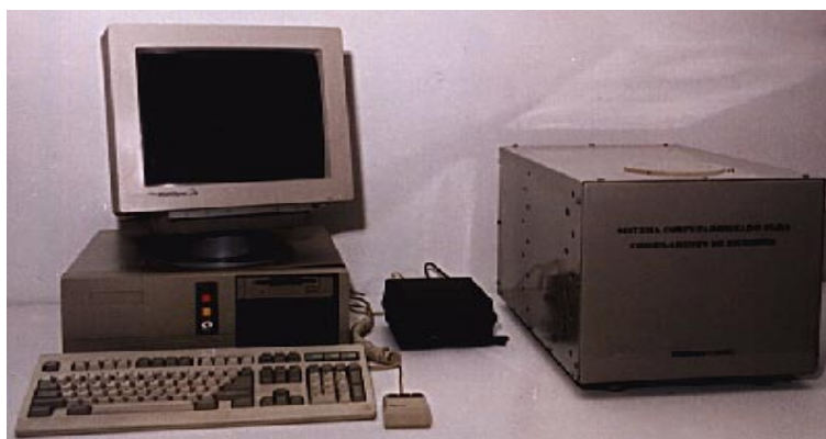
Figura 6: Sistema computadorizado para congelamento de embriões desenvolvido na EMBRAPA-CNPDIA.
