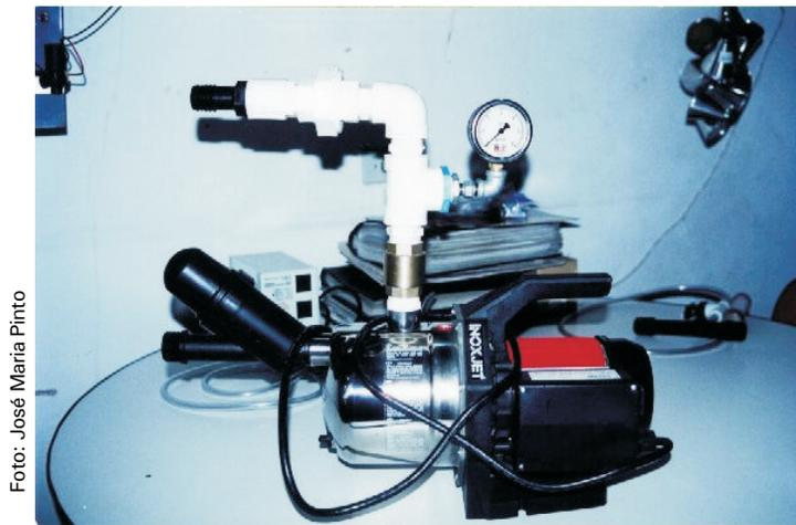
Fig. 2. Bomba injetora tipo pistão com motor elétrico de uma e duas entradas.
