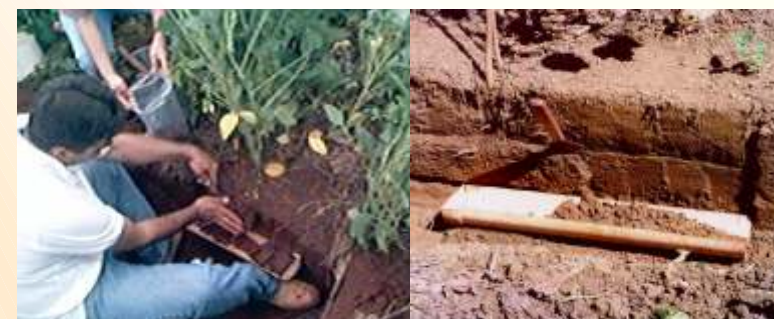
Sistema de coleta de amostras de terra para análise química.
