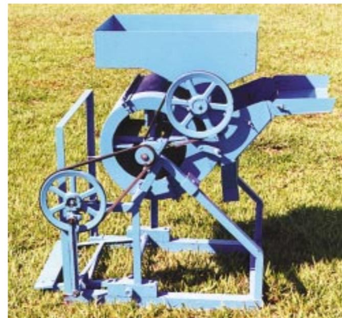
Fig. 2. Abanadora de sementes acionada por pedal.
