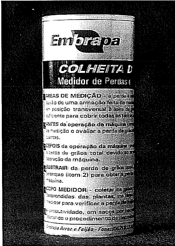
Fig. 1. Medidor de perdas de grãos na colheita do feijoeiro.
